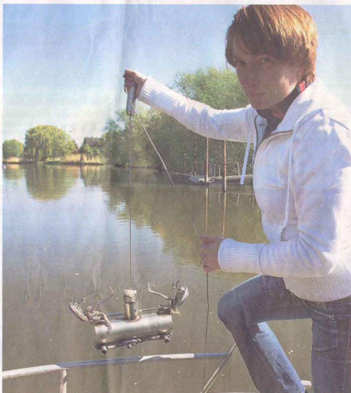
Verschärfte Aufladungen sind ein weiteres (Zukunfts-)Problem, Elbe und Starkregen tragen mehr Sedimente in die Nebenflüsse: Ingenieurin Monika Donner bringt einen Schöpfprobennehmer in der Este bei Cranz aus, später werden die Sedimente in einem Labor der Technischen Universität in Harburg untersucht. Fotos Vasel
