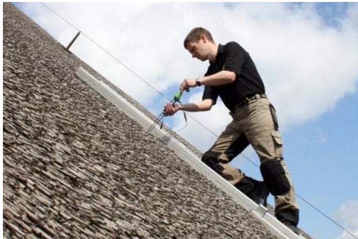
Bedrohte Art: Steffen Slama misst die Feuchtigkeit in einem Reetdach im Hamburger Stadtteil Curslack. Foto: dpa/DPA
