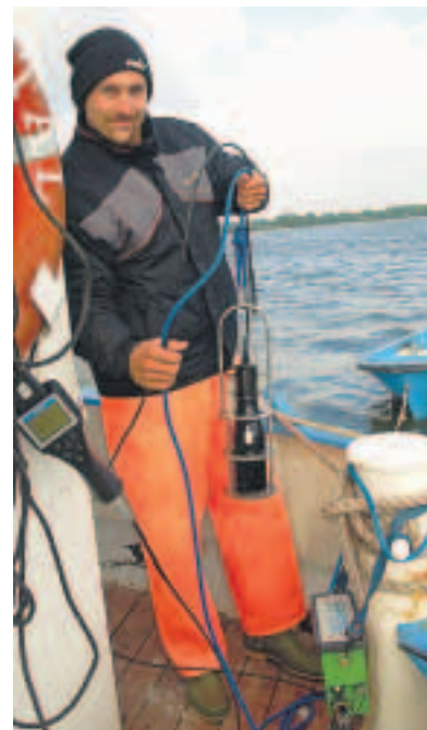
Eine Messsonde liefert weitere Daten – wie den Salzgehalt.
